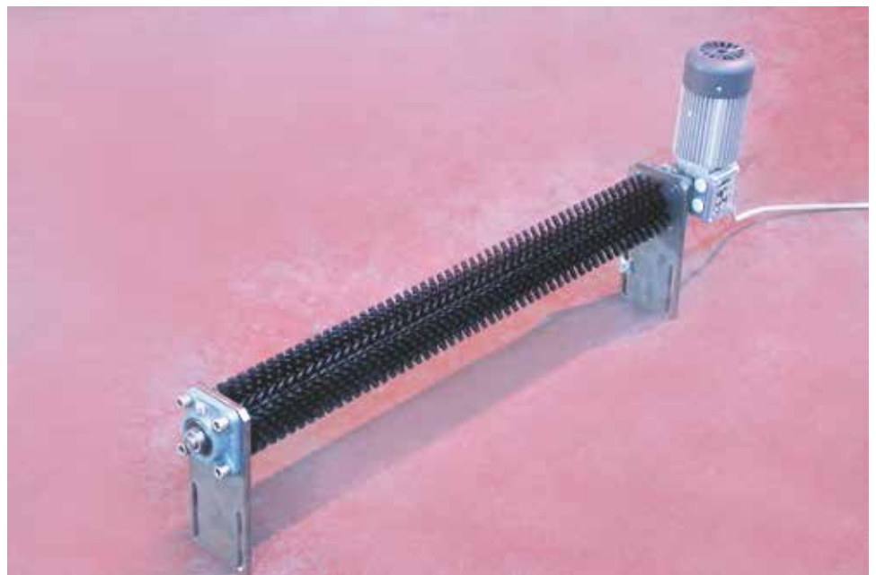
Spazzola motorizzata per pulizia nastri trasportatori
