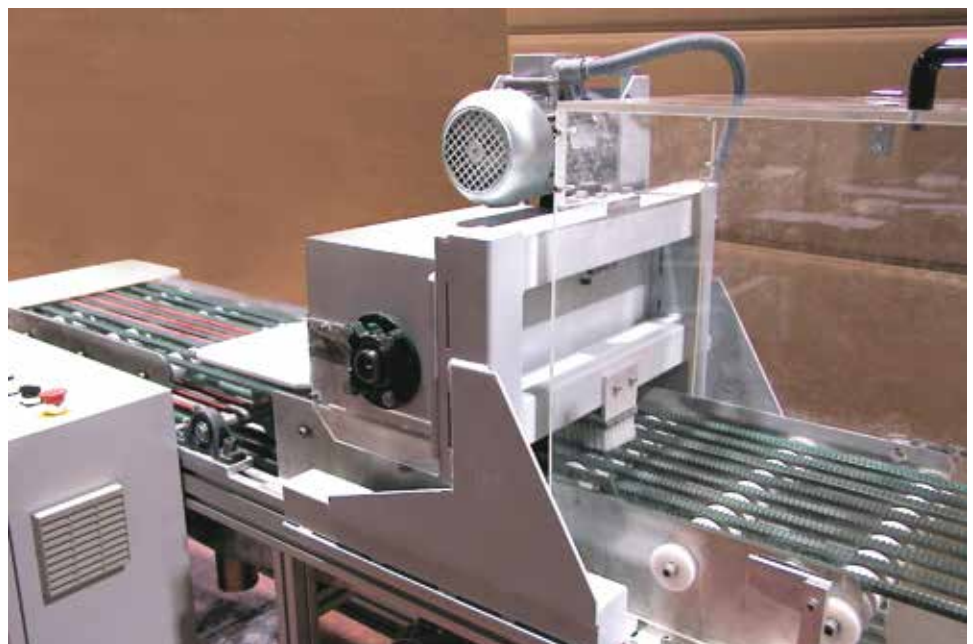
Stazione di levigatura tramite Sandy Brush
