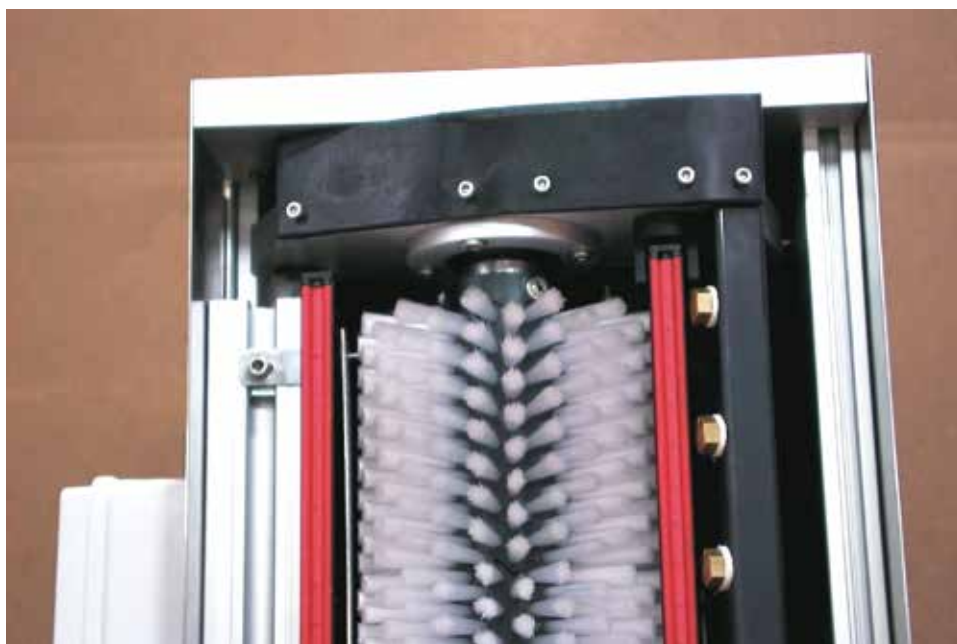
DEP120 – particolare di spazzola e barre antistatiche
