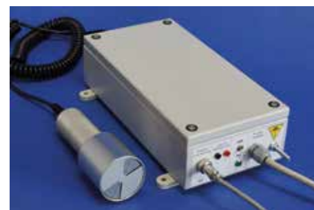
CHARGE METER, misuratore in continuo di carica elettrostatica con soglia di allarme
