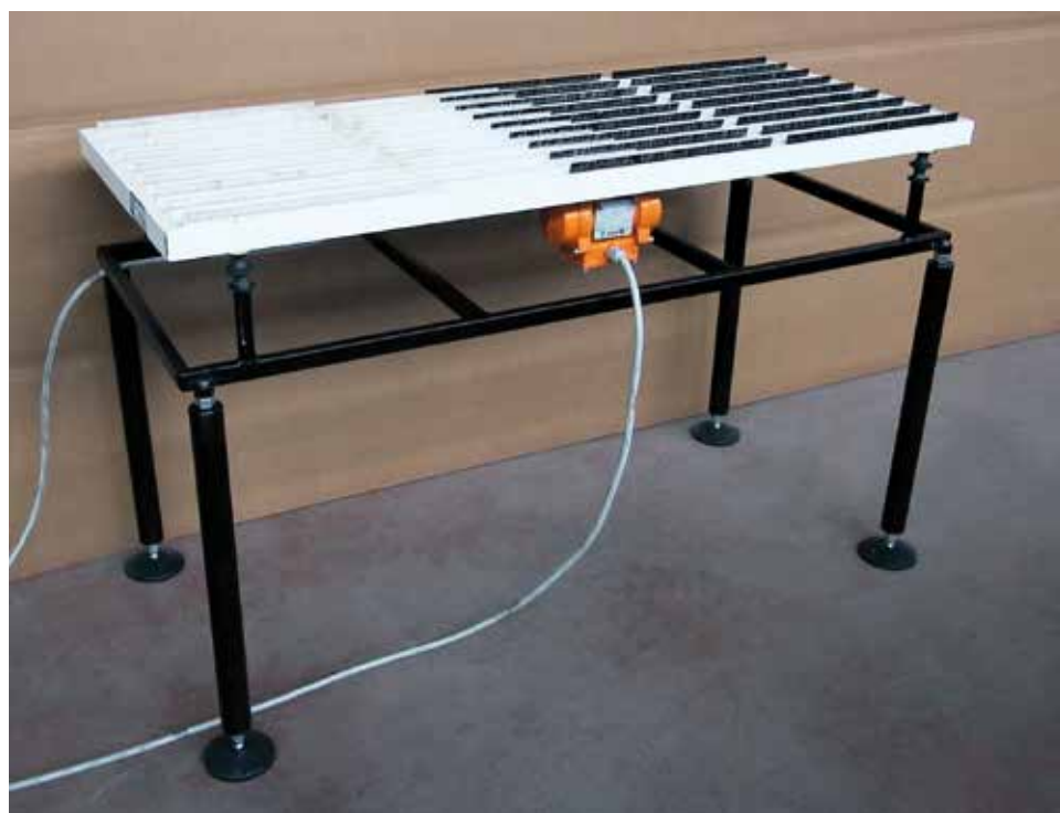
Piano vibrante per movimentazione lamiere con basso attrito
