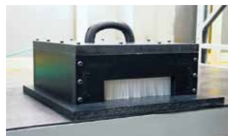
Apparato di prova per fonoisolamento Strip lineare
