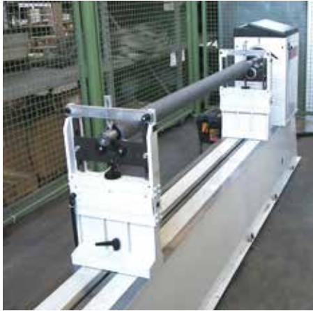
Equilibratrice per il controllo e la correzione dello squilibrio dinamico delle spazzole a rullo.
