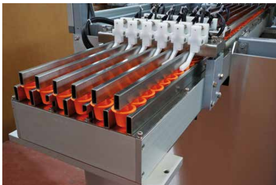
CONV-A Trasportatore ad aria ventilata a 6 piste
